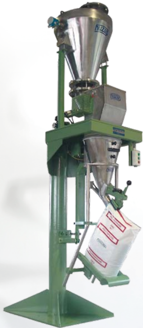
Stationäre elektronische Bruttoabsackwaage für Ventilsäcke Stationary electronic gross weighing scale for valve bags Stacjonarna elektroniczna waga brutto dla worków wentylowych Напольные электронные весы брутто для вентильных мешков
