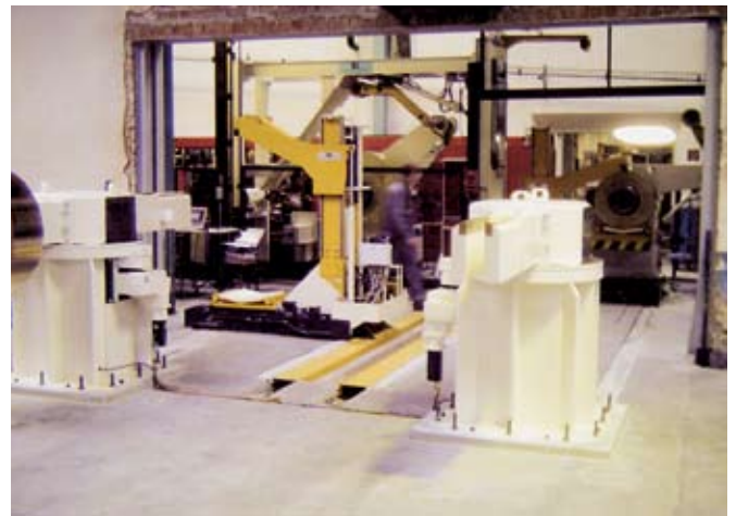
Abwickelgruppe mit Bandüberführung für Glühofenlinie Decoiling group with strip bridging guide for annealing furnace line
