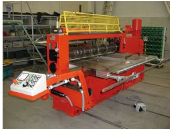
Mehrfachstreifenschere zum Schneiden von Gummipplatten Multiple slitting shear to cut rubber sheet
