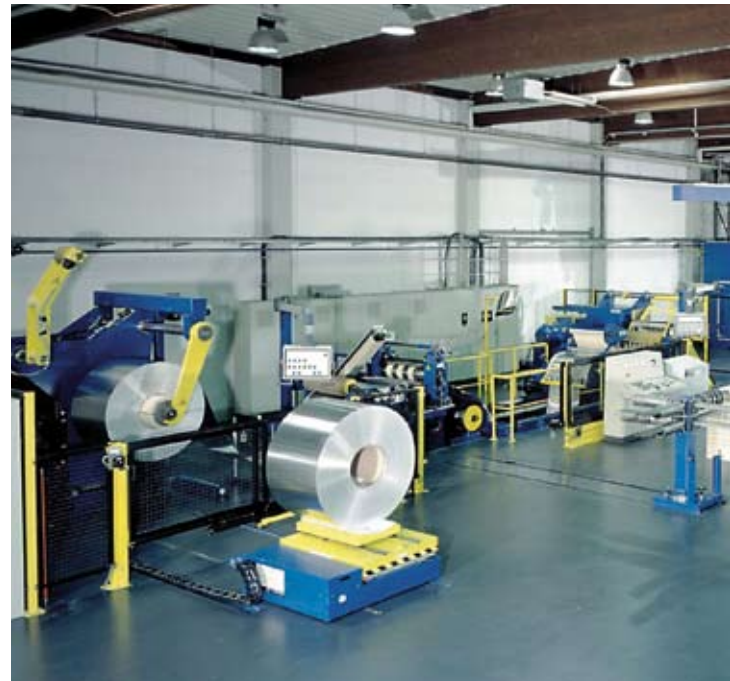
Aluminiumlegierung aluminium alloys | 0,05-1,0mm x 800mm 200 m/min
