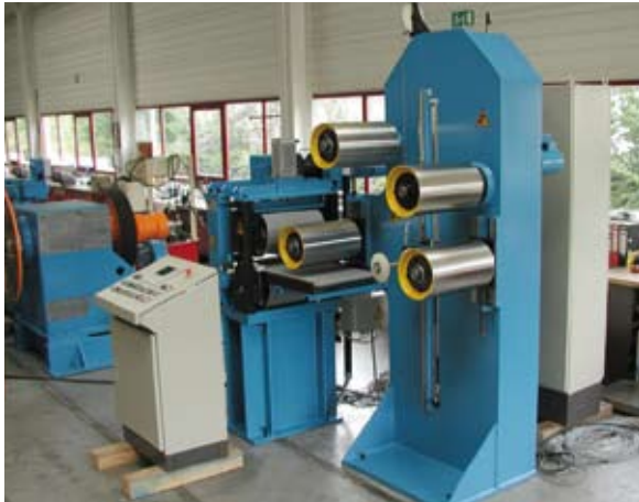
Bandspeicher mit Querteilschere Accumulator with cut-to-length-shear
