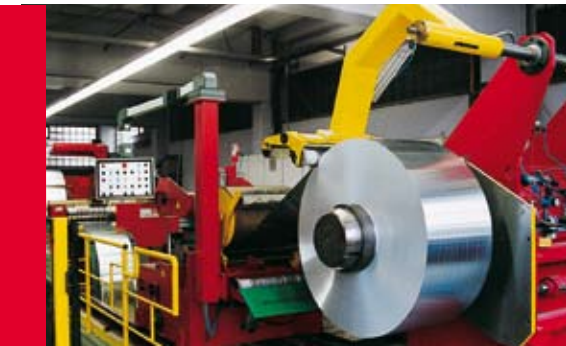
Aluminiumlegierung aluminium alloys 0,1-2,0mm x 620mm 400 m/min
