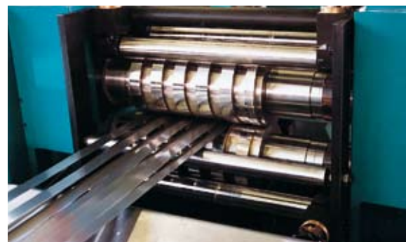
schneiden mit Stahlauswerferringen cutting with steel roll-out rings
