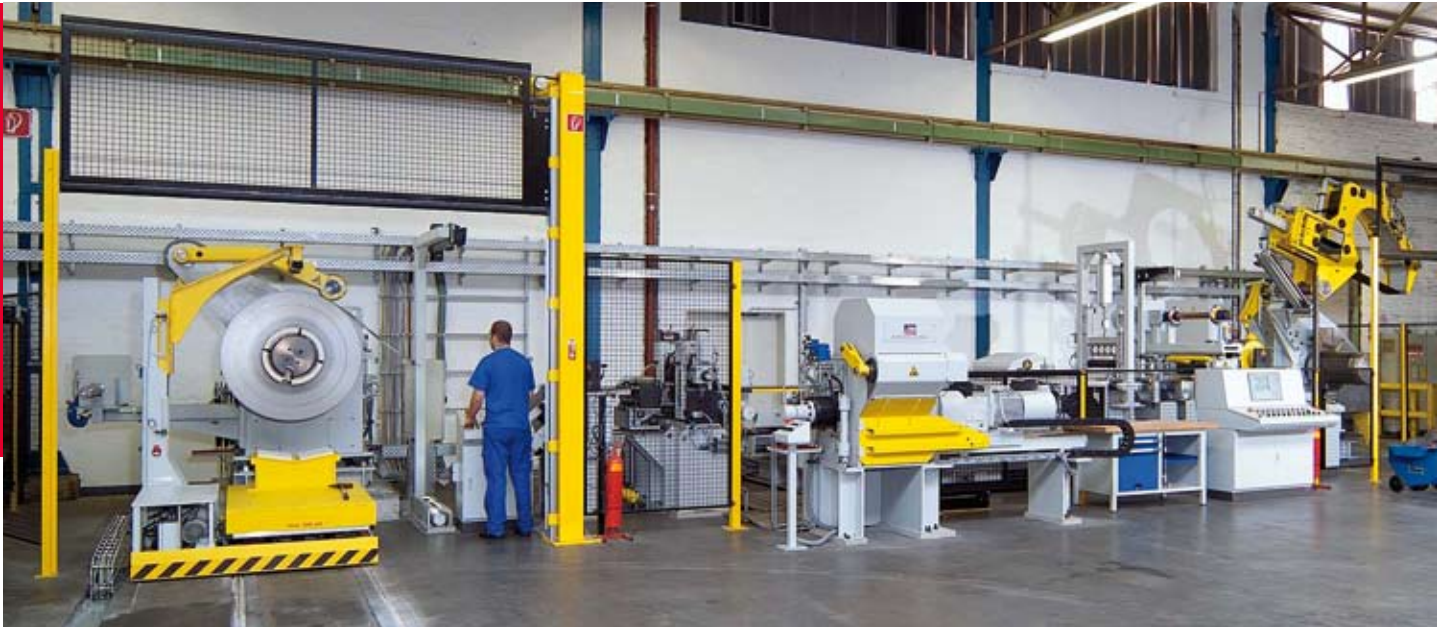
Umwickel- und Besäumanlage mit S-Rollengerüst für Zugabbau Rewinding and edge trimming line with s-bridles for tension reduction
