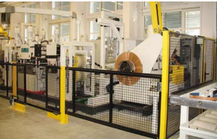
Umwickelanlage mit Präzisions Richtmaschine und Semi-Streck-Biege-Richt-Prozess Rewinding line with precision levelling machine and semi-stretch-bend-levelling-prozess
