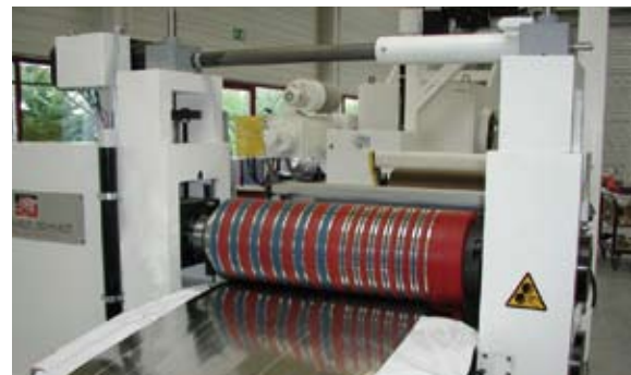
obere Messerwellenanstellung upper knife shaft adjustment
