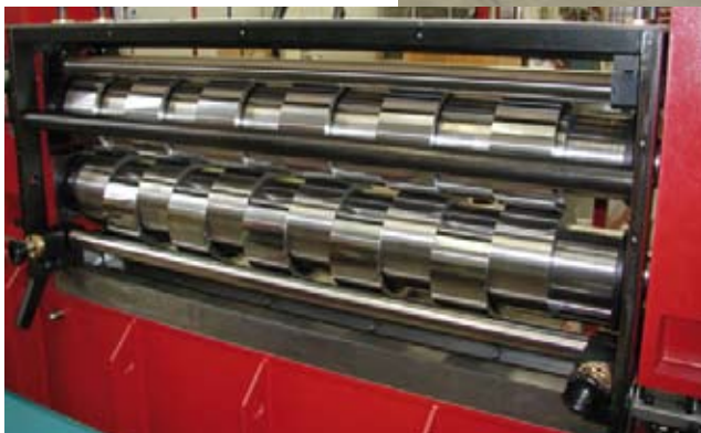
Mehrfachstreifenschere zum Schneiden von Filterplatten Multiple slitting shear to cut filter sheet
