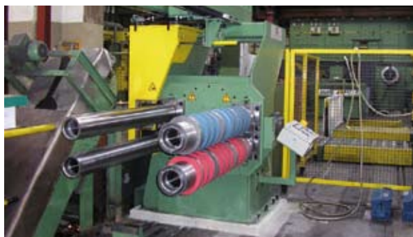
Werkzeugwechsellvorrichtung 2-armig (Revolver) 2-arm tool changing device (Revolver)
