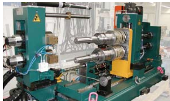
Wechselschere zur Modernisierung einer Altanlage mit vollautomatischer hydraulischer Werkzeugspannung change shear for modernizing an old line with full automatic hydraulic tool clamping
