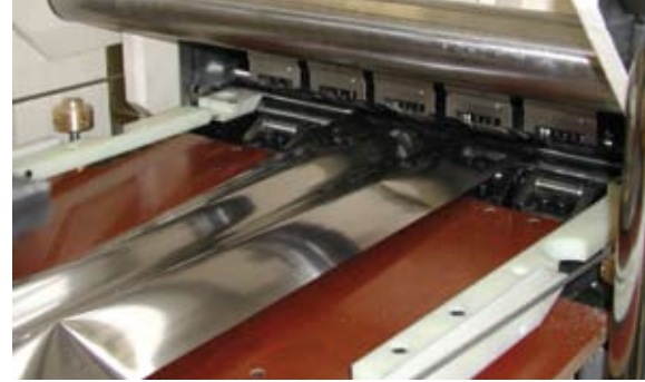
Richtmaschineneinlauf Leveller entry
