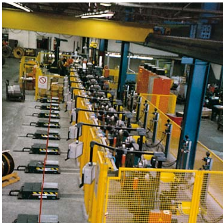
Längsteilanlage mit 9 Verlegespulern Slitting line with 9 traversing spoolers
