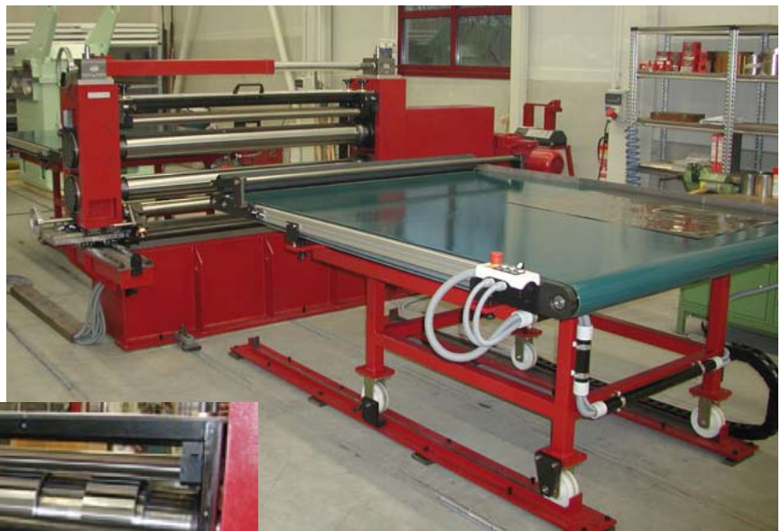
Mehrfachstreifenschere zum Schneiden von Filterplatten Multiple slitting shear to cut filter sheet
