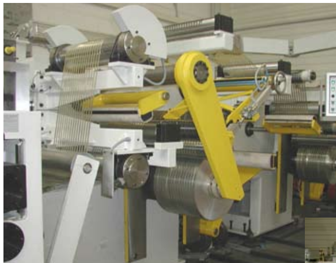
ohne Schlingengrube - mit Friktionswickelwellen without loop pit - with friction shafts
