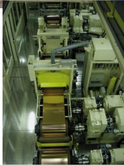
Kupferlegierung | 0,03-0,8mm x 650mm copper alloys | 500 m/min
