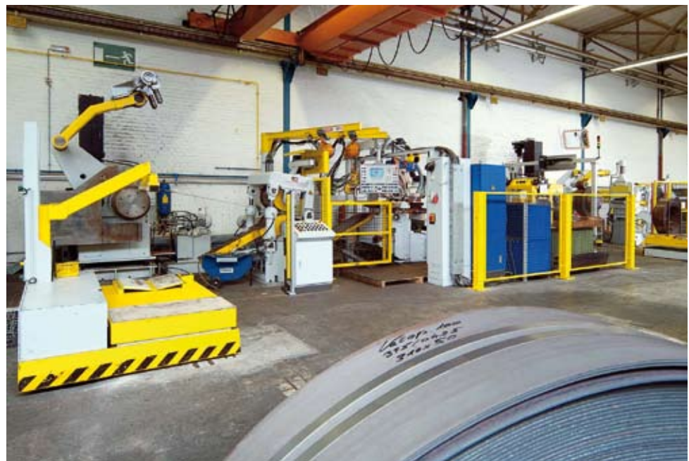
Umwickel- und Schweißanlage Rewinding and welding line
