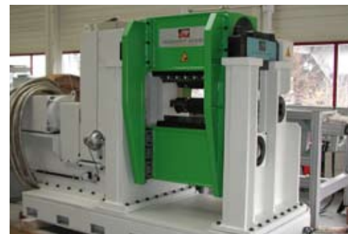
fliegende Schere in Doppel-Exzenter-Ausführung flying shear with double-eccentric drive
