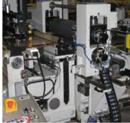
mit automatischer, hydraulischer Werkzeugspannung with automatic, hydraulic tool clamping
