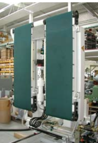
Kipptisch für Einzelringabnahme Tilting table for individual ring removal
