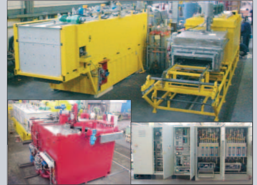
Four à bande avec bac de trempe et four de revenu Conveyor belt furnace with quenching tank and tempering furnace Durchlaufofen mit Abschreckbad und Anlassofen Forno a nastro con vasca di tempra e forno di rinvenimento
