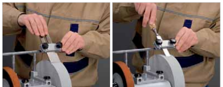
Anwendungsbeispiel: Schleifen von Hobeisen 90°
