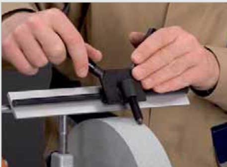
Abrichten des Schleifsteins (Art.-Nr. 380 0029)
