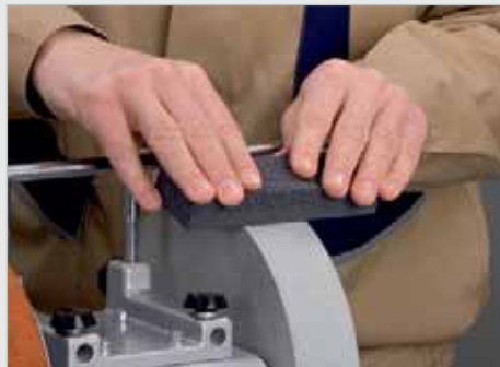
Präparieren (Grob/Fein) des Schleifsteins (Art.-Nr. 380 0030)
