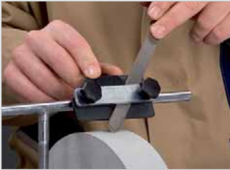
Schleifen von Drehseisen 45° (Vorrichtung Art.-Nr. 380 0015)
