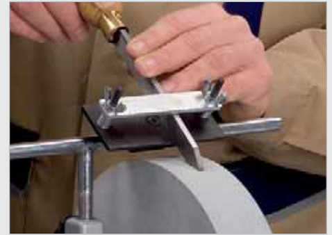
Schleifen von Abstechstäbe (Vorrichtung Art.-Nr. 380 0018)
