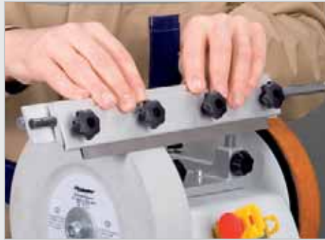
Schleifen von Hobelmesser (Vorrichtung Art.-Nr. 380 0024)
