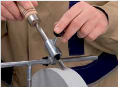
Schleifen von Hohlseisen (Art.-Nr. 380 0021)
