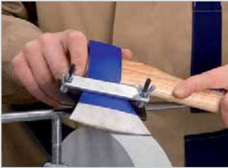
Schleifen von Beilen und Äxten (Vorrichtung Art.-Nr. 380 0018)
