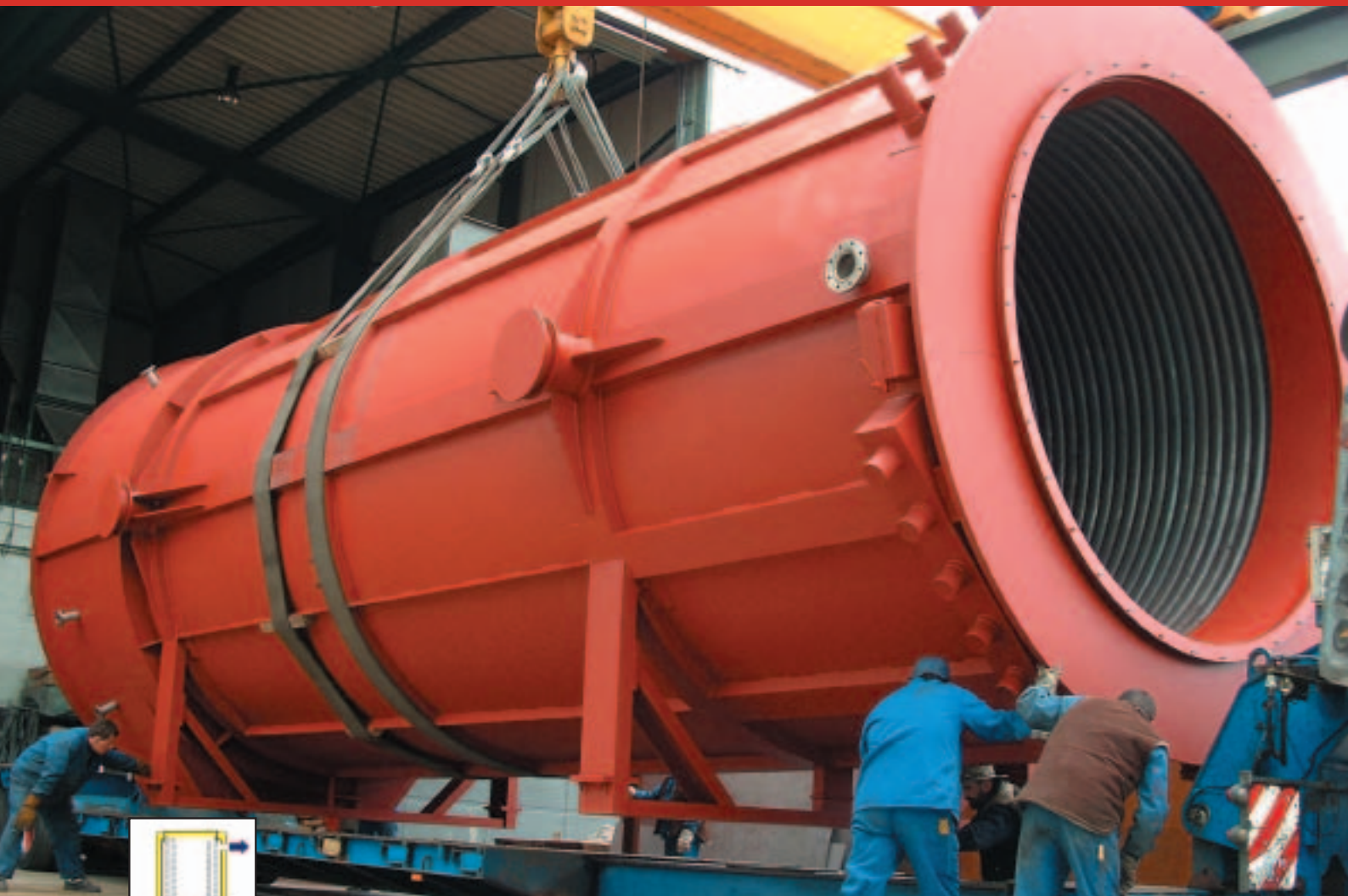
КОНТАКТОМАТ® – Система использования отработанного тепла с интегрированным выдуванием сажи за топкой с передвижной решёткой
