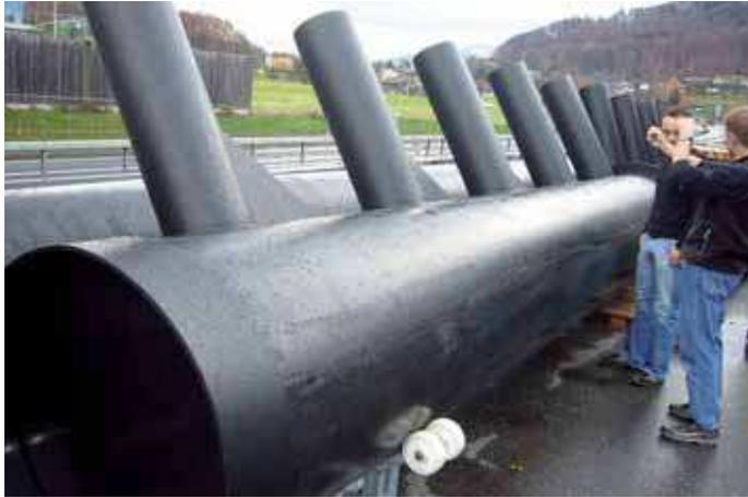
Rohrkonstruktionen aus PE für termische Energiessysteme, Schweiz
