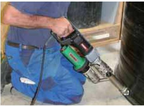
Mit dem langen FUSION 3 lassen sich Schweissnähte in Bodennähe einfach extrudieren.
