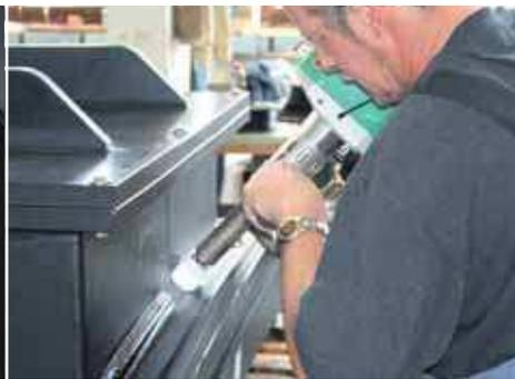
Übersichtliches Arbeiten mit dem WELDPLAST EC4.
