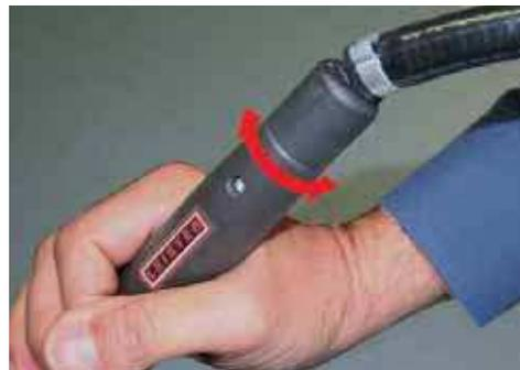
Der drehbare Schlauchadapter am WELDING PEN erleichtert das Arbeiten.
