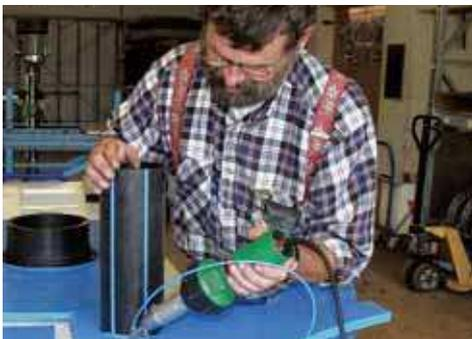
Schweißen eines Formteils mit TRIAC PID und aufgeschobener Schnellschweissdüse.
