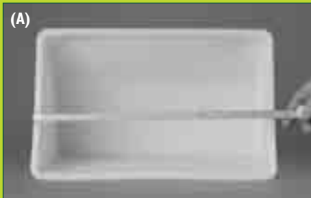
With elevator bucket back laid flat, measure overall length (A). Con la espalda del cangilón plano, medir el largo completo (A).
