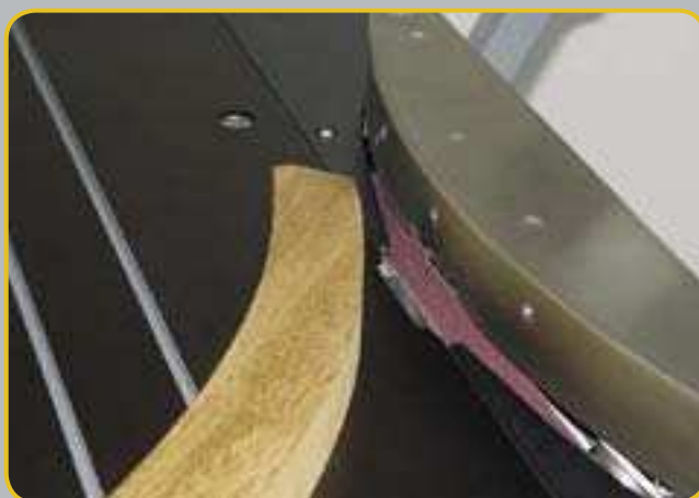
Bogenschleifeinrichtung zum Schleifen von Radien und Fasen. Bow sanding attachment for sanding from radius and chamfer.
